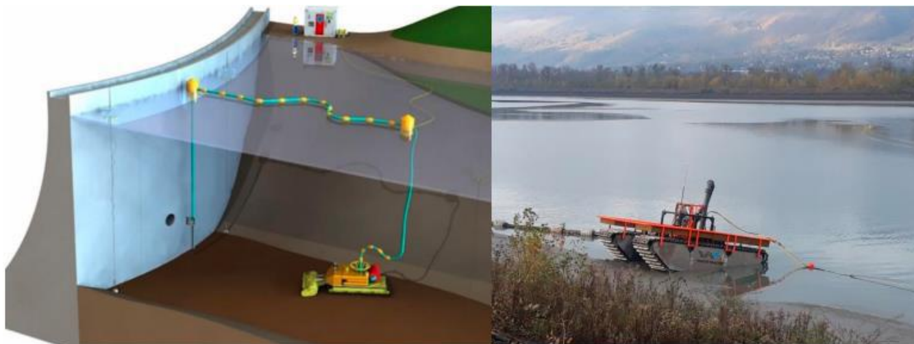
Figure 6 : Principe de fonctionnement du robot NESSIE (Source : Egis et EDF)
